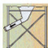
Modele 42 Fond pour vidange gravité avec tube 2 m fl 30 + trappe
